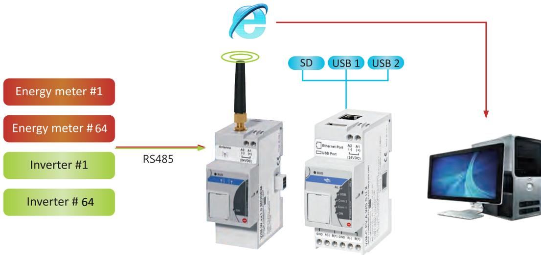
**C4:** 搭配無線傳送模組VIM-W, 直流串列監測 stringMoni® 模組, 無線通訊模組, 環境量測模組及自動控制設定模組進行即時監測。
