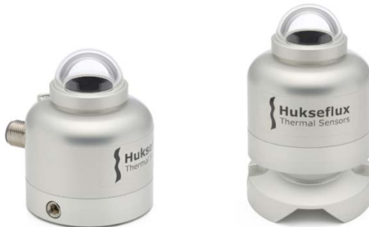
圖0.2左側 SR05數位二級日射強度計，帶有氣泡水準儀和 M12-A 電纜連接器，採用標準配置（包括3米電纜標準）；右側 SR05 帶有可選的球形調平功能，便於在（非）水準表面上安裝和調平（未顯示隨附的安裝螺栓）
