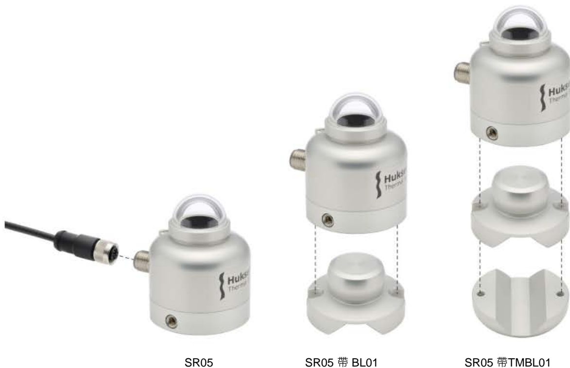
圖 5.2.1 從左到右：標準配置的 SR05，帶 3 米電纜；帶有可選的滾珠調平功能，便於在（非）水準表面上安裝和調平；帶有可選的滾珠調平和管安裝，便於安裝在直徑為 25 至 40 mm 的管子上。安裝螺栓包含在球調平和/或管安裝中。
