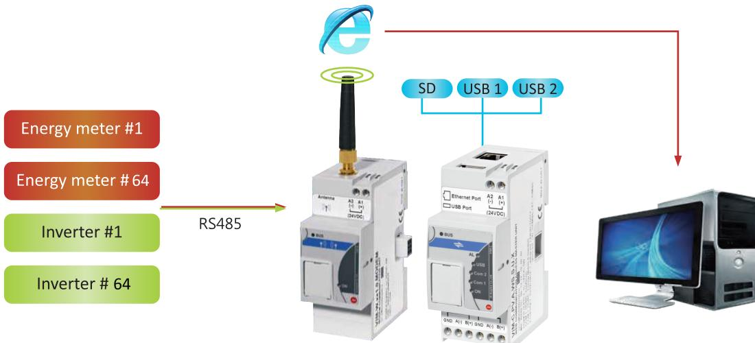
C4:搭配無線傳送模組VIM-W,直流串列監測 stringMoni® 模組,無線通訊模組,環境量測模組及自動控制設定模組進行即時監測。
