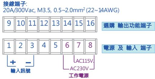
接線時，請務必確認電源電壓是否正確並接入正確端子編號。為設備及儀表安全，建議在儀表前安裝保險絲(Fuse) 或 斷路器(Breaker)。
