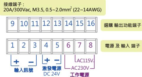
接線時，請務必確認電源電壓是否正確並接入正確端子編號。為設備及儀表安全，建議在儀表前安裝保險絲(Fuse)或 斷路器(Breaker)。
