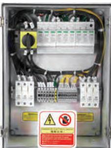
三串輸出。配置IP67防水箱、6P 1000Vdc直流開關1個或2P三個、直流保險絲及座6個(正負極各3個)、突波保護器3個、適用三只追蹤器之逆變器、6~10kW太陽能發電系統、或依開關電流額定適用10~25kW太陽能發電系統。
