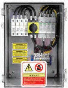
二串輸出。配置IP67防水箱、4P 1000Vdc直流開關1個或2P二個、直流保險絲及座4個(正負極各2個)、突波保護器2個。適用二只追蹤器之逆變器、4~6kW太陽能發電系統、或依開關電流額定適用10~25kW太陽能發電系統。
