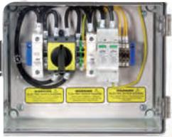
單串或多串併接為一串輸出。配置IP67防水箱、2P 1000Vdc直流開關一個、直流保險絲及座2個(正負極各一個)、突波保護器一個。適用一只追蹤器之逆變器、2~3kW太陽能發電系統。
