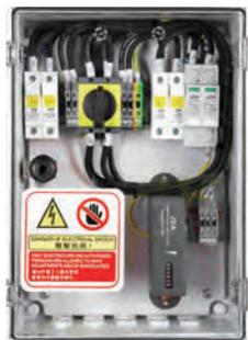
二串輸出。配置IP67防水箱、4P 1000Vdc直流開關1個或2P二個、直流保險絲及座4個(正負極各2個)、突波保護器1個、一個雷擊計數器。適用二只追蹤器之逆變器、4~6kW太陽能發電系統或依開關電流額定適用10~25kW太陽能發電系統。
