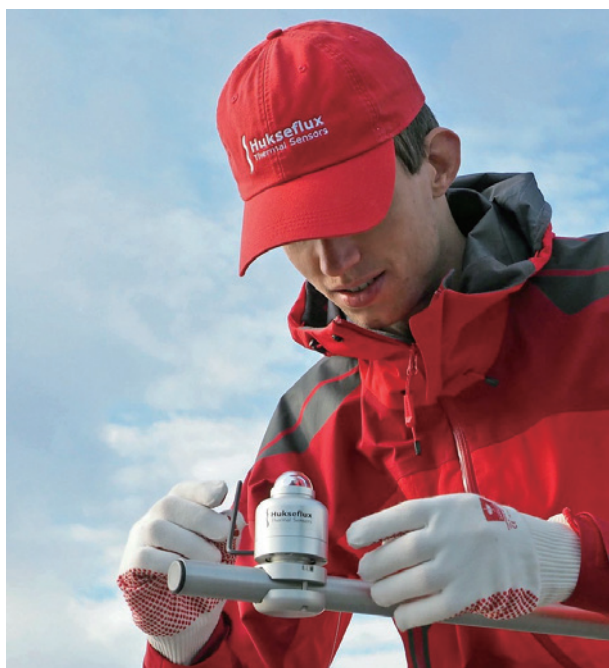
圖 2 SR05 使用管型扣件與球型水平座可輕鬆調整校正水平交度。SR05 使用工業標準數位以及類比輸出。
